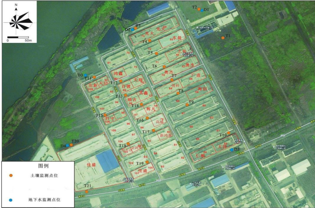
图5.1-1 土壤和地下水布点图
